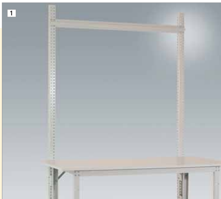
Aus Profilstahl 60 x 55 mm, Befestigung an Tischgestell hinten, Zubehörkomponenten im Raster von 30 mm höhenstellbar, Nutzhöhe über Tisch 1500 mm.
