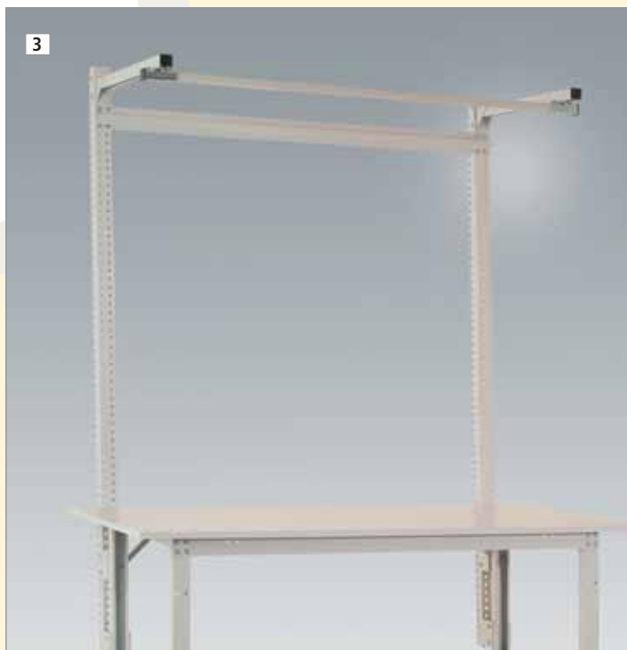
Aus Profilstahl 60 x 55 mm, Befestigung an Tischgestell hinten, Zubehörkomponenten im Raster von 30 mm höhenstellbar, Tragkraft 40 kg bei Tiefe 350 mm, Tragkraft 25 kg bei Tiefe 700 mm, Nutzhöhe über Tisch 1500 mm.
