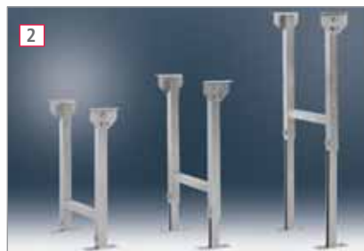
2 Doppelgelenk-Rahmenständer wird zur Einhaltung der Bahnen-Tragkräfte alle 1500 mm oder für Kugel-Rollentisch benötigt. Aus Stahl verzinkt. Stufenlos höhenverstellbar von 650–1020 mm. Tragkraft 200 kg.
