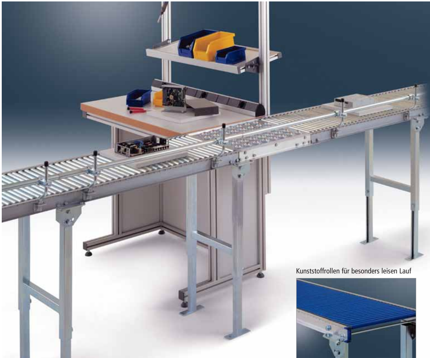
Klein-Rollenbahnen, Tragkraft 50 kg (daN)/lfm bei 1500 mm Ständer-Abstand, Bauhöhe 61,5 mm
